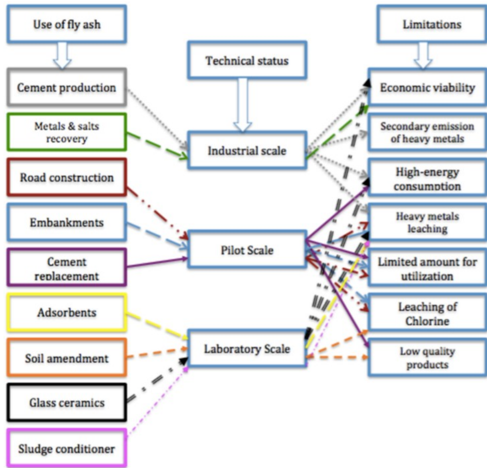
Figur 7 Illustration af anvendelsesmuligheder for flyveaske fra affaldsenergianlæg. Teknisk status og begrænsninger er angivet. 26
