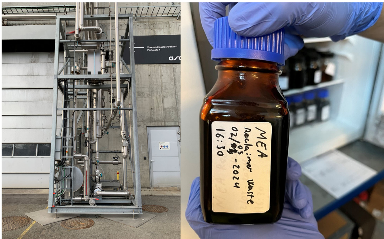
Figur 1: (Venstre) Billede af reclaimerenheden på carbon capture demonstrationsanlæg. (Højre) Billede af aminslam fra reclaiming af et MEA solvent.
